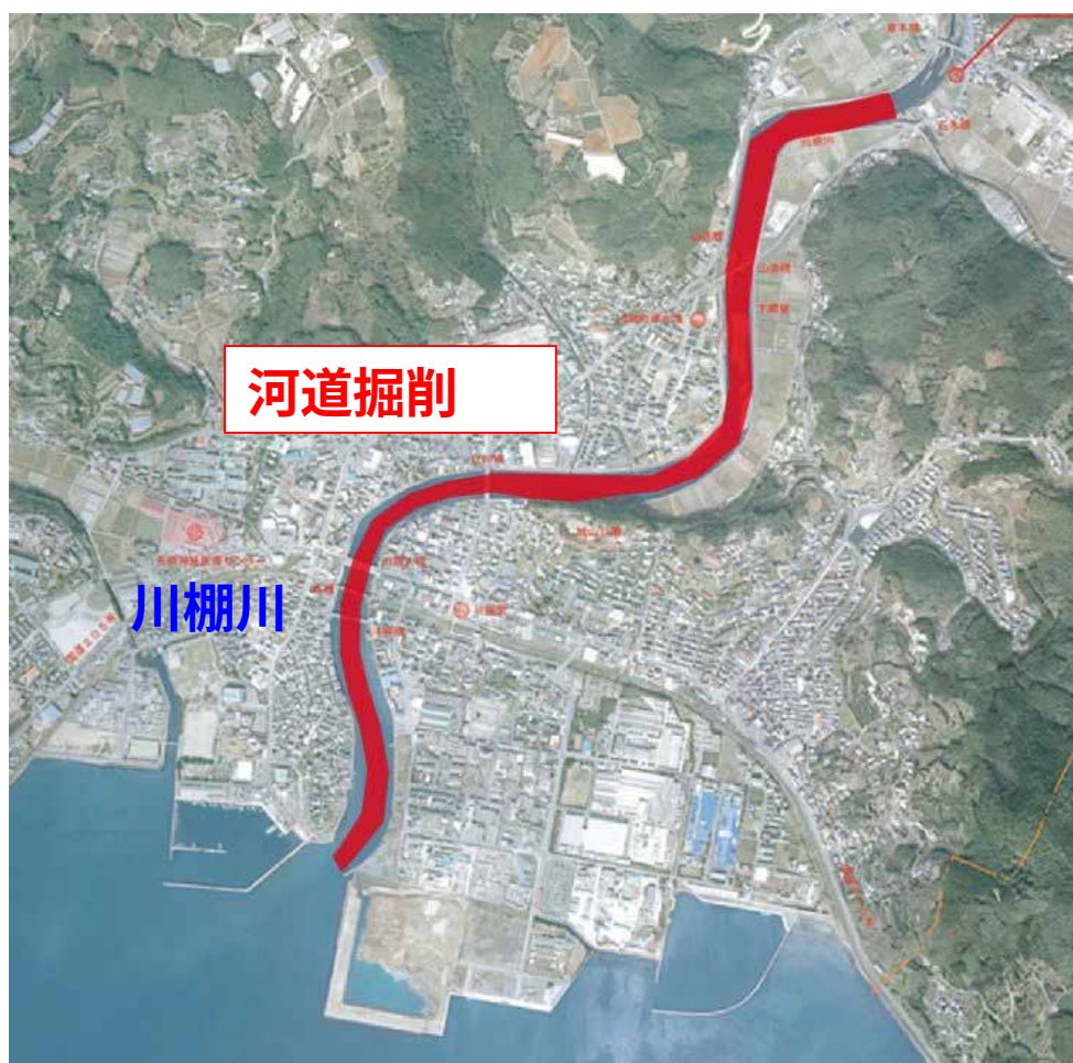
図 4.3.13 河道掘削案計画平面図
