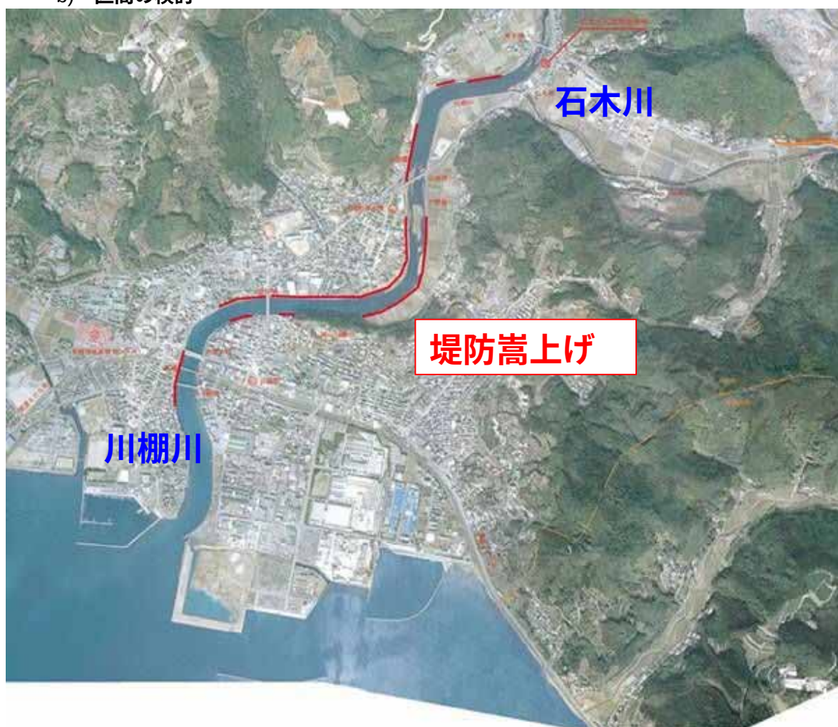
図 4.3.19 堤防嵩上げ案計画平面図
