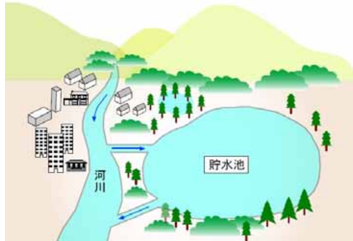
図 4.6.7 河道外貯留施設（貯水池）イメージ図
