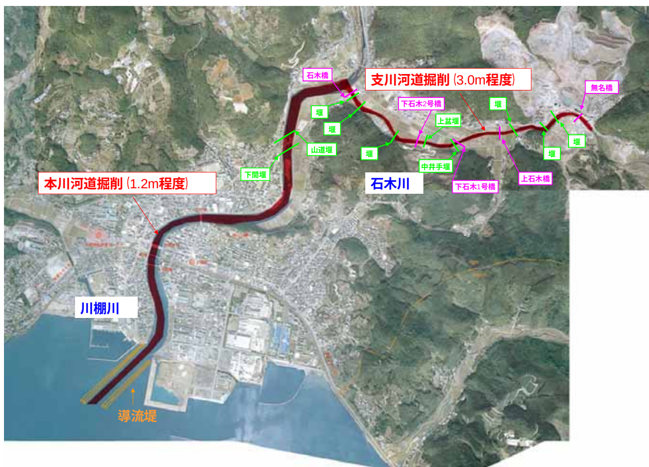
図 4.3.60 河道掘削案位置図
