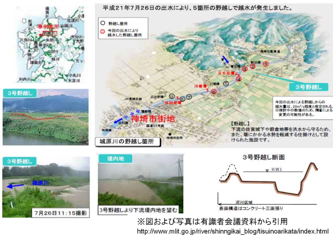
図 4.3.35 部分的に低い堤防の存置 イメージ図
