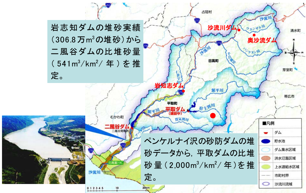
図3 報告書における比堆砂量推定のために選定した岩志知ダムとペンケルナイ沢の砂防ダムの存在地 (ペンケルナイ沢砂防ダムは平取ダム建設予定地の右の赤丸)
