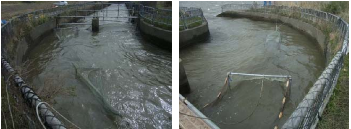
写真 4.3.1 魚道上流におけるふくろ網設置状況
