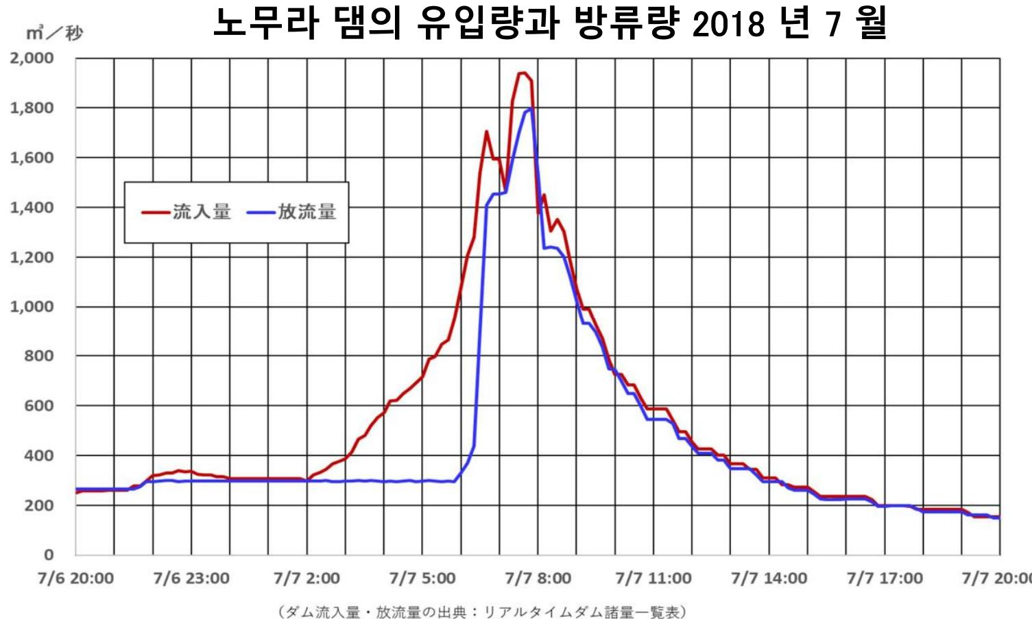
노무라 댐은 댐 유입량이  $300\text{m}^3/\text{초}$ 에서  $1400\text{m}^3/\text{초}$ 까지 약 4 시간 반 만에 상승했다. 반면, 방류량은 한 시간 만에  $300\text{m}^3/\text{초}$ 에서  $1400\text{m}^3/\text{초}$ 까지 급 상승 했다.
