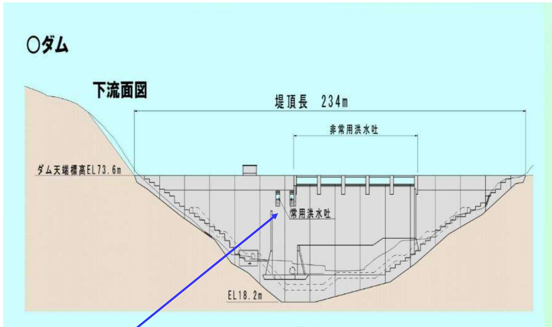
石木ダムの常用洪水吐 高さ2.4m、幅2.0mの2門
