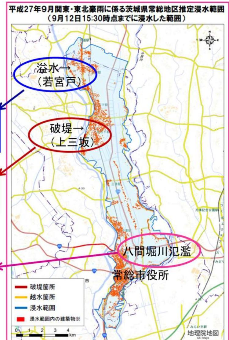
鬼怒川下流部の左岸25km付近、左岸21km付近は左岸、右岸を通じて、現況堤防高が周辺より一段と低く、大規模溢水や堤防決壊の危険性が最も高い場所であり、2015年9月水害では溢水、破堤が現実のものとなりました。
