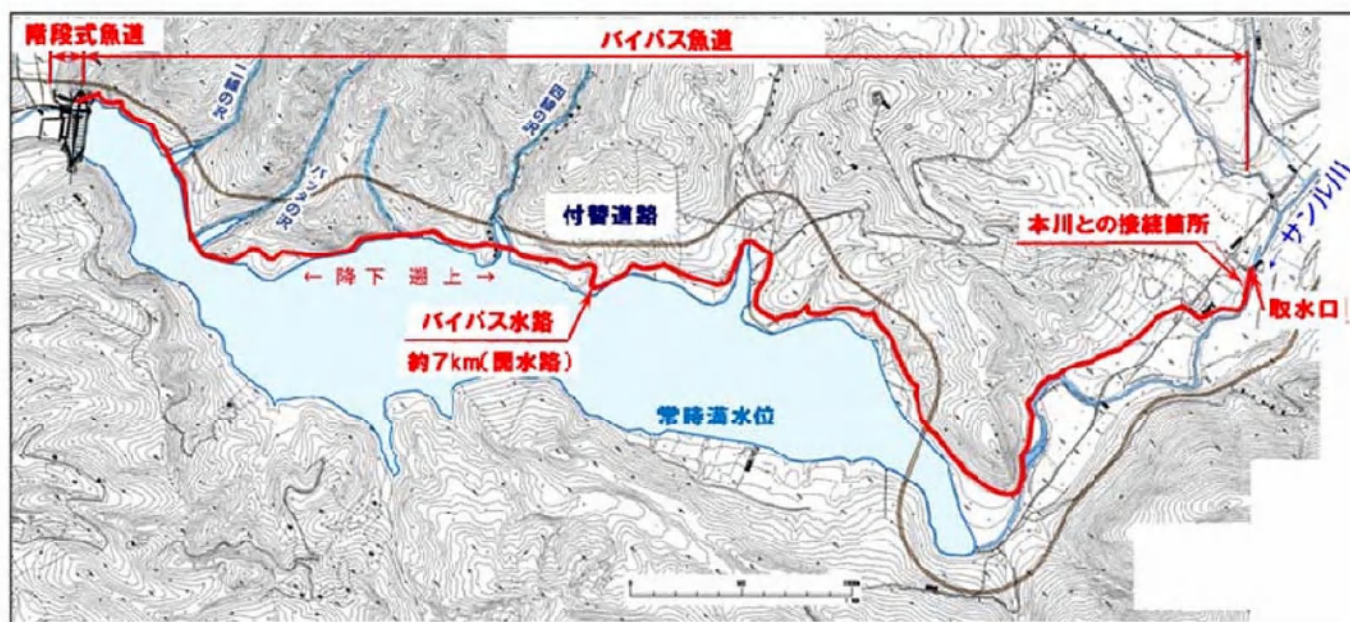
図- 19 サンルダム魚道全体平面図
