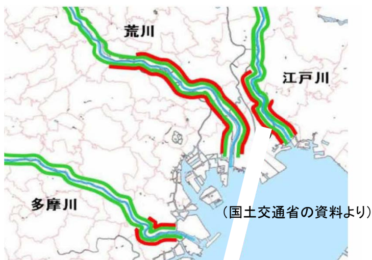
図2 見直し後の高規格堤防の整備区間
