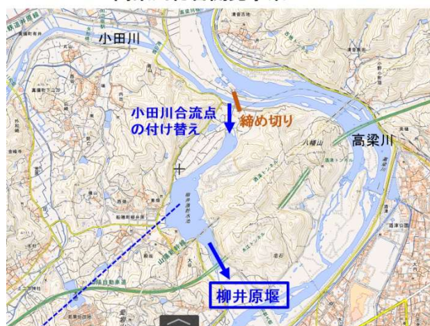
柳井原貯水池 湛水面積 100ha 貯水容量 約340万 \text{m}^3 目的: 水道用水の供給等
