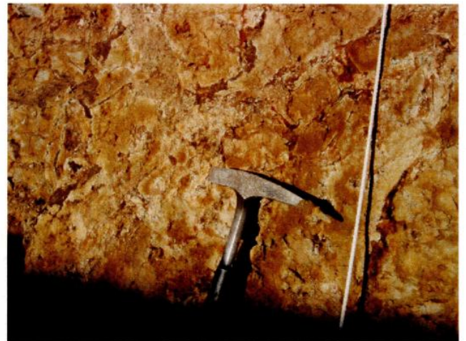
CLL 級：強風化岩塊と基質部が視認でき、D 級岩盤より明らかに硬い。
