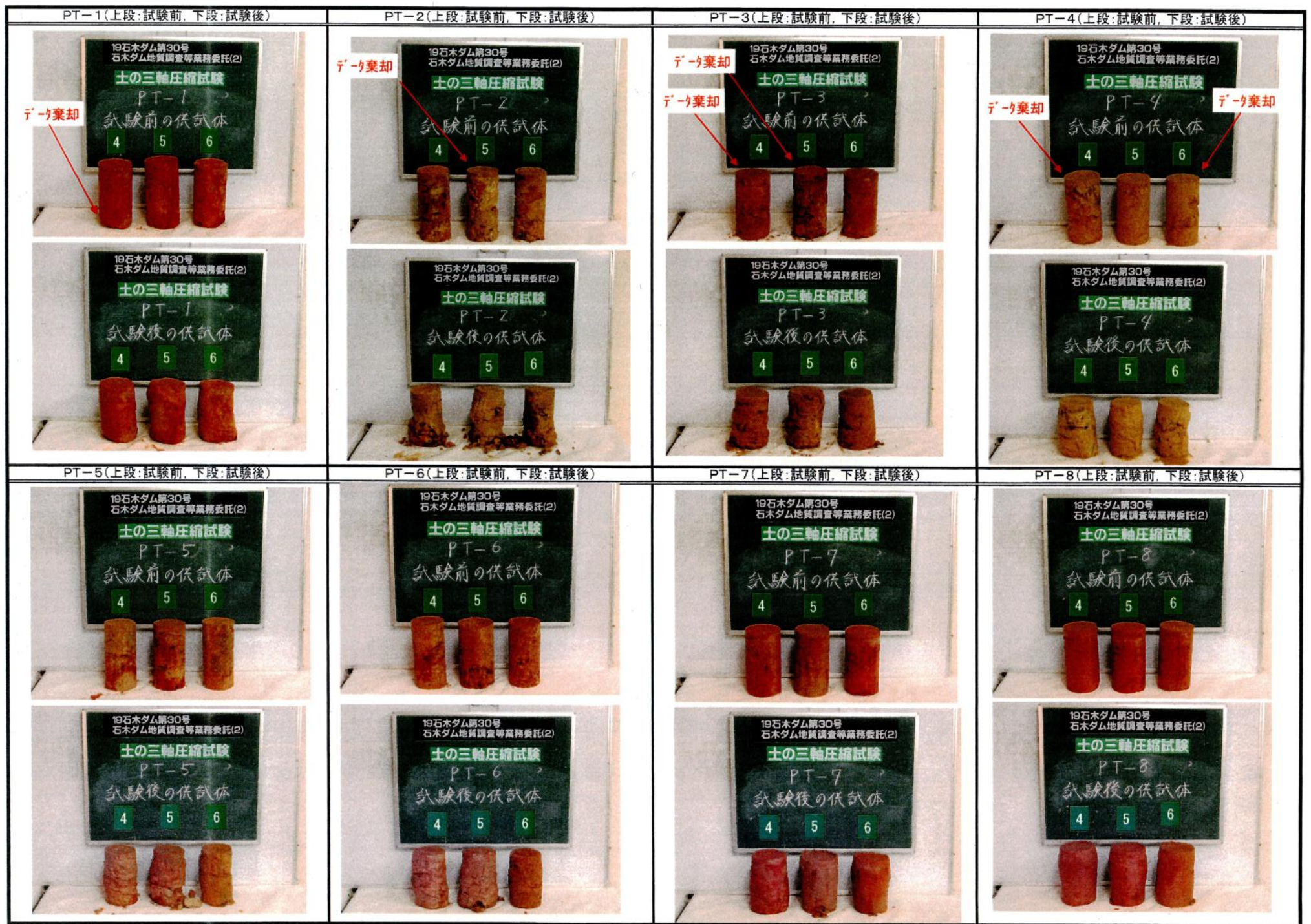
写真-5.3.8 三軸圧縮試験(UU)供試体写真
