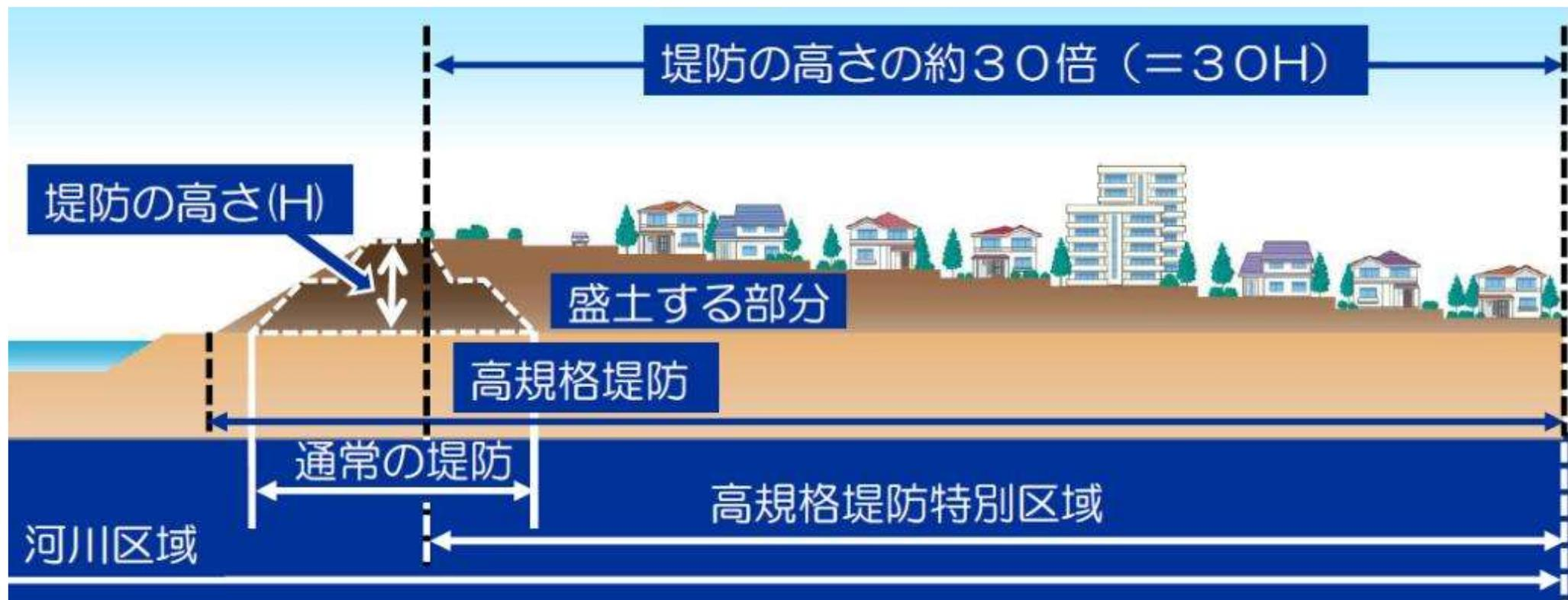
通常の堤防は法面の幅が高さの数倍だが、スーパー堤防は裏法面の幅が30倍になる。
