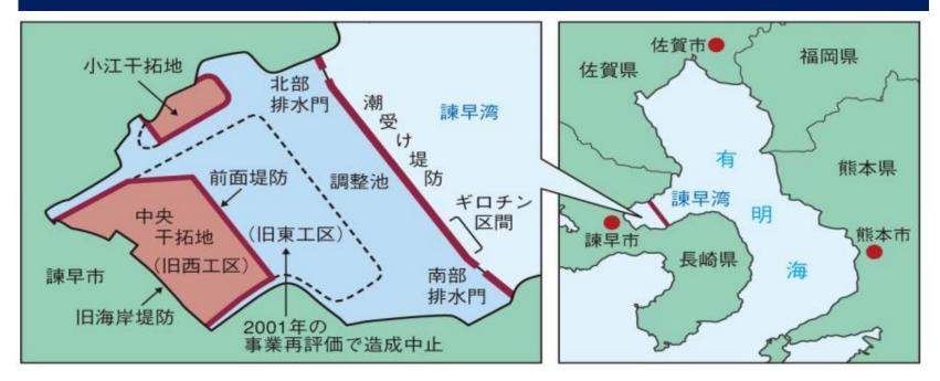
有明海異変:赤潮頻発→底層の貧酸素化→漁業被害は、 諫早湾の堤防閉め切りによる潮流潮汐減少が主因。 開門(調整池への海水導入・海水交換の復活)すれば、 調整池の汽水化、干潟の再生、潮流潮汐の回復により、 漁業回復・地域の分断解消=有明海再生が期待できる。
