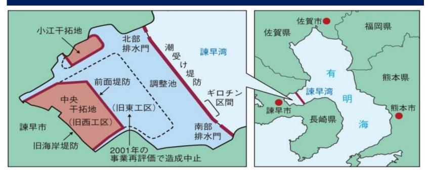
諫早湾の奥部、3550haを潮受堤防で閉め切り、 淡水の調整池と農地を造成する複式干拓事業。 目的は優良農地の造成と防災機能の強化。 1989年着エ→1997年堤防閉切→2008年営農開始。 2000年12月赤潮大発生→ノリ大不作→開門が焦点に。
